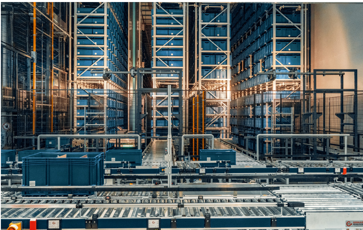
Abbildung 3: Automatisches Kleinteilelager als Beispiel eines komplexen Logistiksystems
