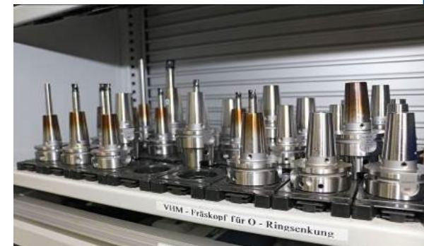
Vormontierte Duo-Lock Werkzeuge in verschiedenen Durchmessern und Längen
